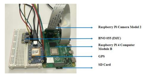
Figure 5. Edge device prototype.
