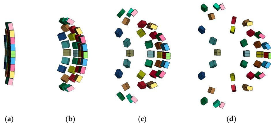
**Figure 5.** Projectile process of fragments (Different colored squares are fragment groups). (a) 10  $\mu\text{s}$ ; (b) 30  $\mu\text{s}$ ; (c) 60  $\mu\text{s}$ ; (d) 90  $\mu\text{s}$ .
